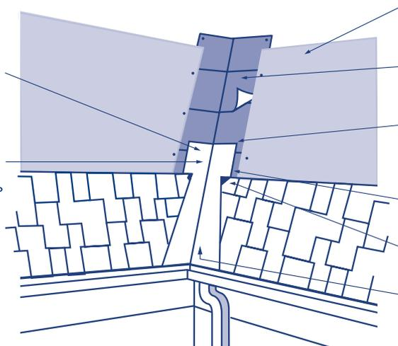
Уложите в желоб подкладочный материал Deck-Armor™ или иной корпорации GAF на гидроизоляционную мембрану с минимальным нахлестом 150 мм.
