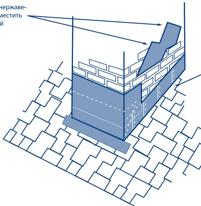
Основа гидроизоляции - нержавеющей металл. Гидроизоляция шириной одной черепицы для каждого ряда. Проклейте в этом месте и прибейте 2-мя гвоздями. Соедините с выше лежащей черепицей с помощью битумного пластичного клея
